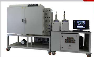
Рисунок 1 - Установка для проведения фильтрационных исследований Autoflood 700
